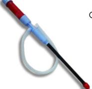
Corpo in polipropilene Tubo rigido 41 cm Tubo flessibile 62 cm Pompaggio 5-6 L/min Funzionamento a **batterie**
